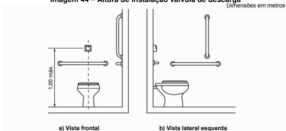
Imagem 44 – Altura de instalação válvula de descarga
